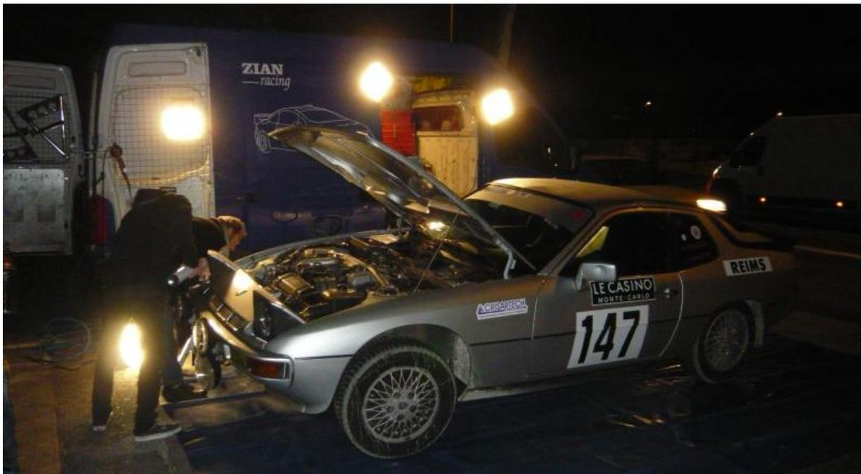
On se prendrait presque pour un équipage en WRC. Le rapide check-up de l'auto ne montre qu'un léger jeu dans une rotule de direction. Les mécanos vont s'en procurer une neuve pour la monter le soir en fin de boucle à Tournon sur Rhône. Mais le modèle est différent et on repartira avec notre vieille rotule pour terminer le rallye. Sur une propulsion, le jeu se sent bien moins que sur une traction.
